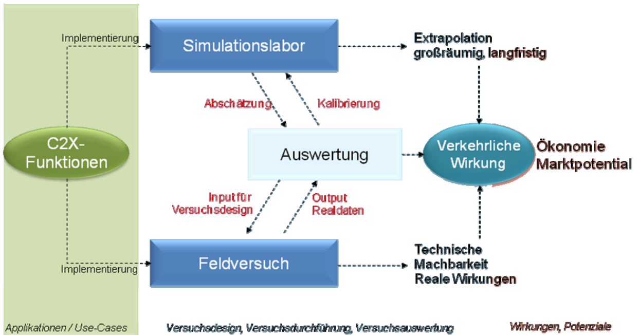
Abb. 4: Zusammenspiel von Feldversuch (Versuchsgebiet und Testgelände) und Simulationslabor (Fahr- und Verkehrssimulation) in \text{sim}^{\text{TD}} Integration of real traffic (test field and test area) and simulation (driving and traffic simulation) in \text{sim}^{\text{TD}}
